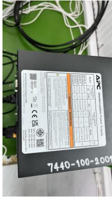
ป้ายระบุคุณลักษณะ UPS ขนาด ๒ kVA
