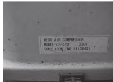
ป้ายบอกรายละเอียดเครื่องอัดอากาศ (Air compressor)
